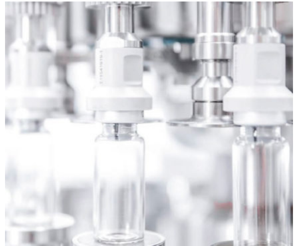
Vials werden gebördelt. Diese Station ist so platziert, dass zuvor noch ein Gefriertrocknungsprozess eingebunden werden könnte, sollte sich bei Incog der Bedarf dafür abzeichnen.
