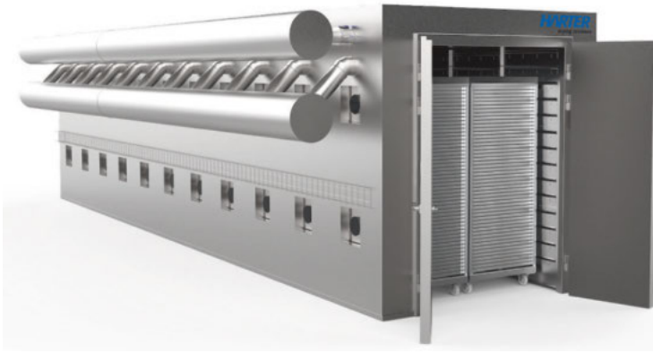
Der Trockner besteht aus elf Kammern und nimmt insgesamt 132 Palettengestelle auf. Die Nennleistung des Wärmepumpentrockners im Produktionsbetrieb liegt bei 33 kW
