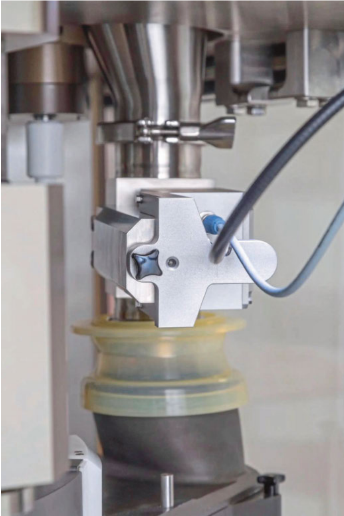
Beispielhafter ePAT-Messkopf (integrierter Nahinfrarotsensor im Füllrohr einer Rundläufer-Tablettenpresse)
