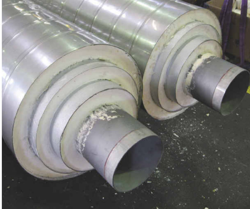
Firesafe-Brandschutz wird durch eine Konditionierung des Polyurethanschaums in Verbindung mit konstruktiven Maßnahmen in Form ein- und mehrschichtiger Wärmedämmung erreicht
