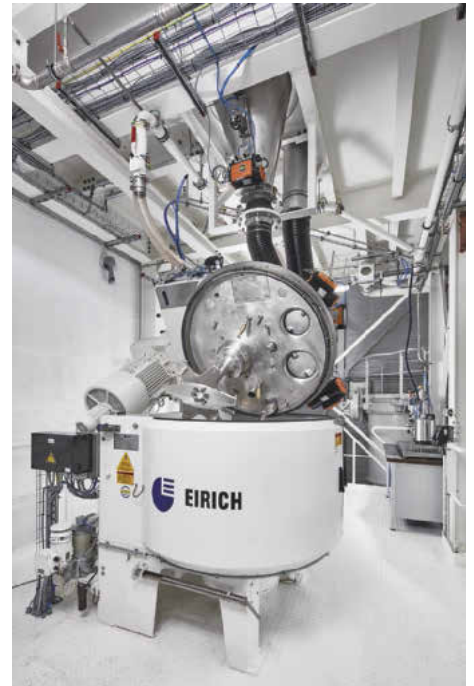
250-l-Mixsolver in einer 1,5 GWh Slurry-Produktionsanlage: Der Mischbehälter ist für die Reinigung leicht zugänglich
