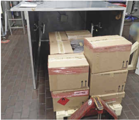
Selbst die Mischpalette mit unterschiedlichen Gebinden und nicht ausgerichteten Datenträgern erkennt die Shipment Verification Station prozesssicher und ausreichend performant
