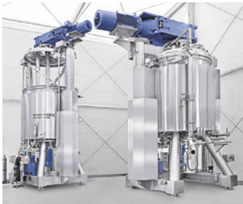
Industriegetriebemotoren im Blockgehäuse im Einsatz bei der Zahncremeproduktion
