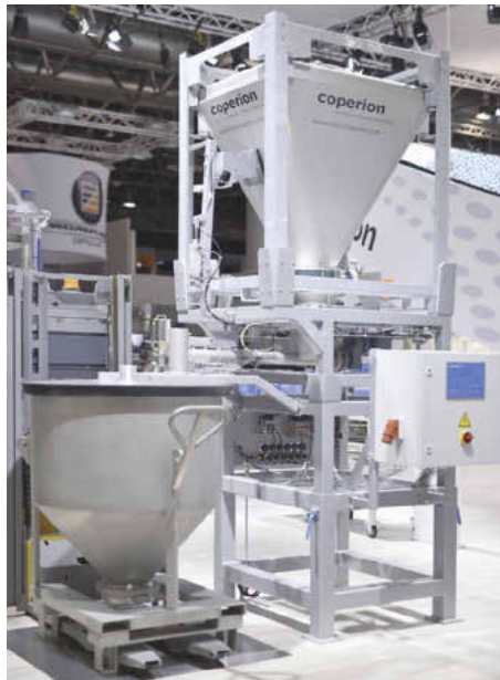
ADD-A-LOT ist ein modulares System für die vollautomatische gravimetrische Dosierung
