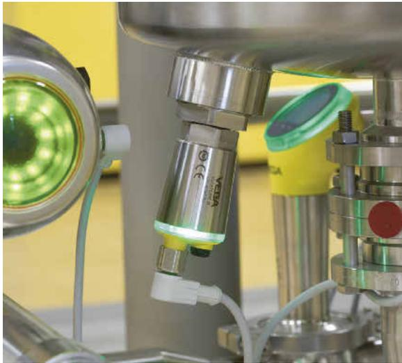
Die standardisierten Anschlüsse der Hygieneadapter sind frei wählbar und stehen für minimalen Aufwand und hohe Anlagenverfügbarkeit.
