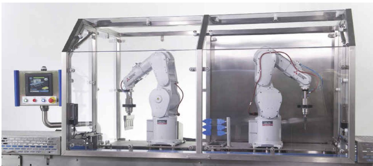
Die beiden Roboterarme von Mitsubishi Electric lassen sich auf die Bandgeschwindigkeit einstellen. So können sie alle vorgesehenen Schnitte in der Bewegung ausführen
