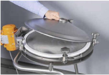
Sterngriffe aus Edelstahl ermöglichen eine werkzeugfreie Bedienung der JEL Fix II und einen einfachen Zugang zu den Siebeinlegern
