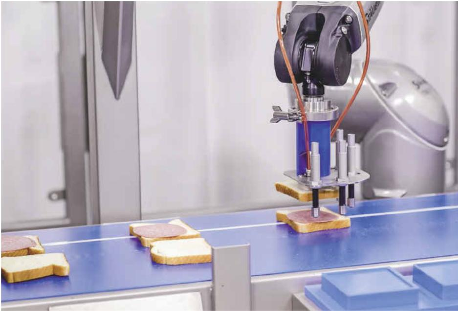
Sechssachs-Roboter TX2-60 HE für hygienesensible Bereiche mit Greifer und Sandwich
