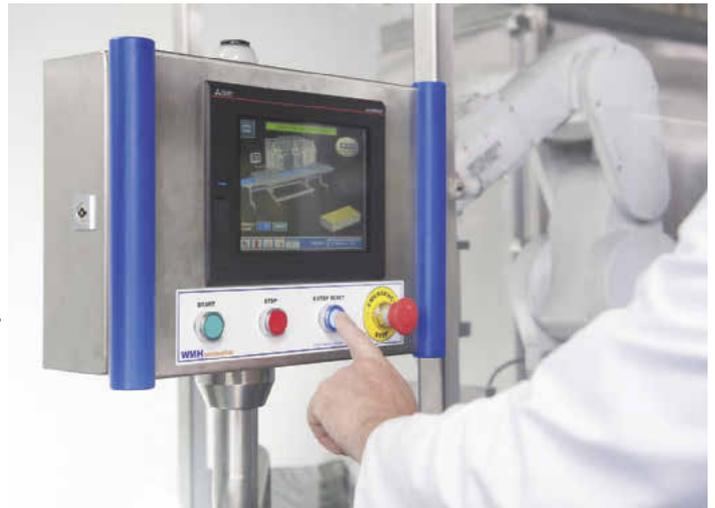
Die sechssachsigen Melfa-Knickarmroboter der Serie RV-F von Mitsubishi Electric zeichnen sich durch hohe Taktraten und Präzision sowie die Schutzklasse IP 65 für Nassreinigungsumgebungen aus
