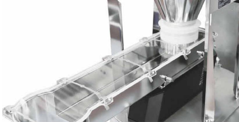
Schnellwechsellclammen im Deckel ermöglichen den schnellen Austausch der Rinne
