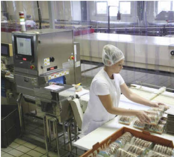
Ein Röntgenprüfsystem wird meist am Ende der Produktionslinie vor der Endverpackung platziert.
