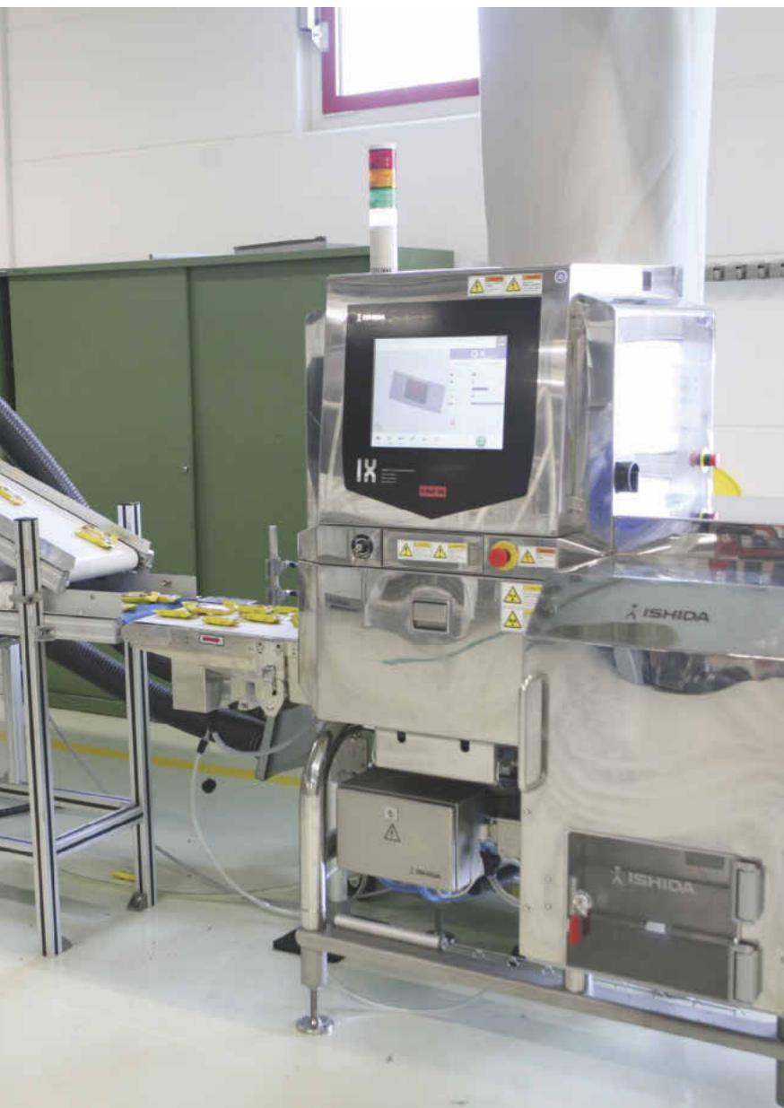
Ein Röntgenprüfsystem bei der Kontrolle von Schokoriegeln.
