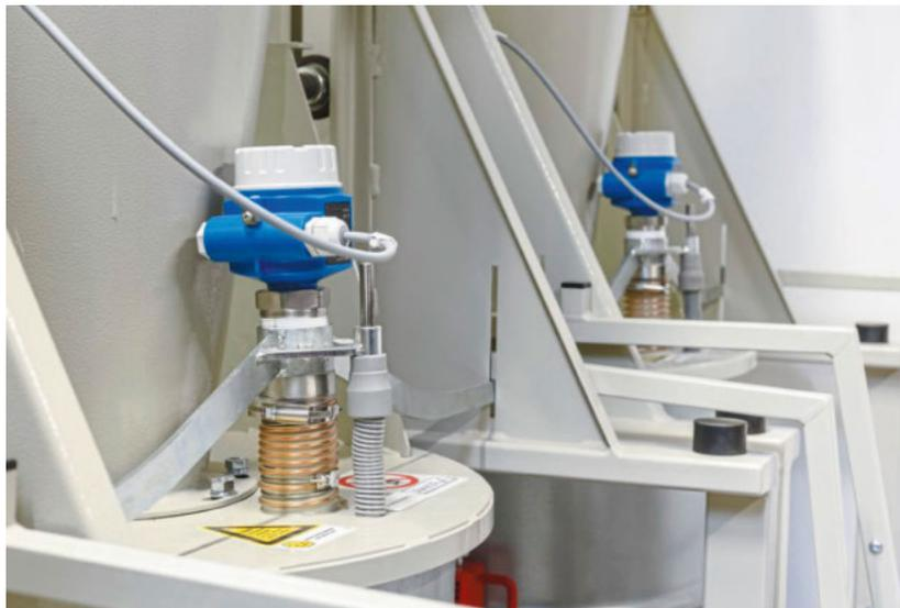
Füllstandüberwachung bei einer Absauganlage mit Schwinggabelsensoren
