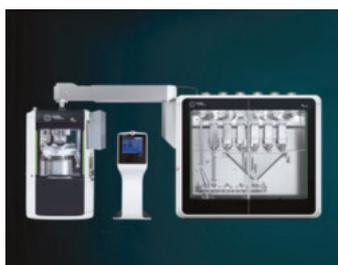
**8 Titel** Eine Direktverpressungsline von Fette Compacting zeigt im Pilotversuch, wie prozesssicher und effizient ein Continuous-Manufacturing-System Pulver verarbeiten kann.
