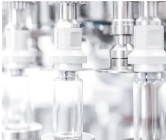
Vials werden gebördelt. Diese Station ist so platziert, dass zuvor noch ein Gefriertrocknungsprozess eingebunden werden könnte, sollte sich bei Incog der Bedarf dafür abzeichnen.
