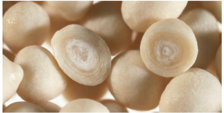
Zwiebelförmige Struktur in einem Aminosäuregranulat
