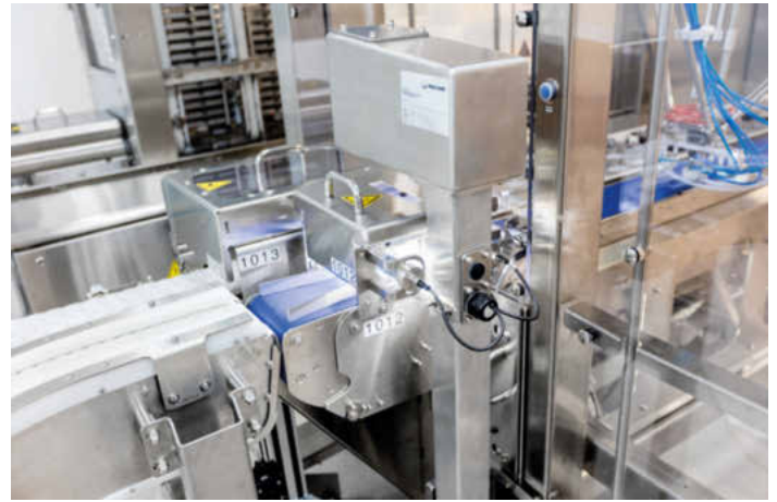
Ein Vision-System prüft die aufgedruckten Daten und die Orientierung der Ampullen
