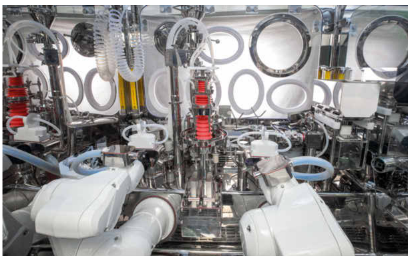
In der Mikrodosiermaschine Microrobot 50 von Romaco Macofar arbeiten drei Stericlean-Roboter der TX2-Serie von Stäubli
