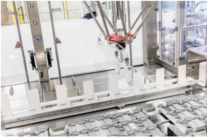
Die Produkte werden vom Handhabungsmodul H 242 in Faltschachteln abgelegt
