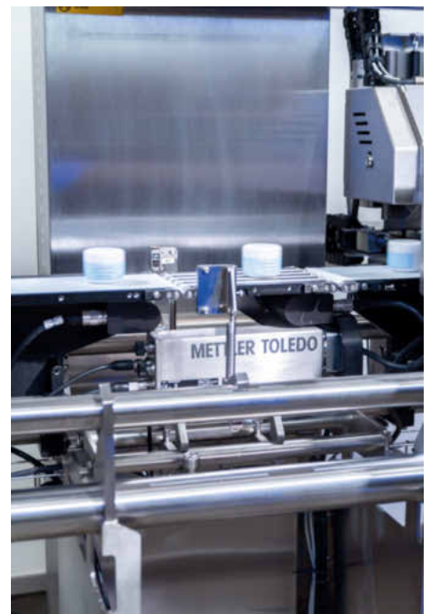
Die Kontrollwaagen können mit der Geschwindigkeit von Kartonierern Schritt halten und pro Minute bis zu 700 leichtgewichtige Blisterpackungen auf ihre Vollständigkeit hin überprüfen
