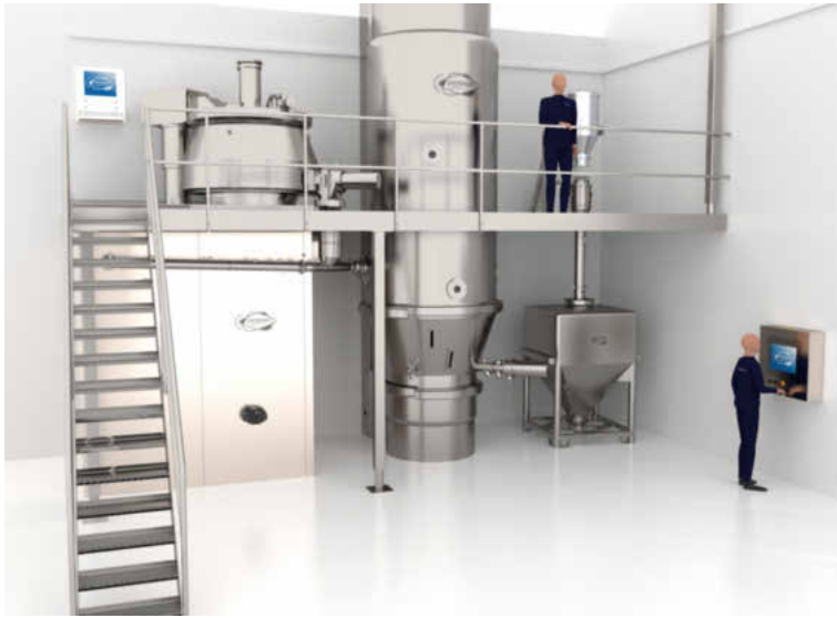
Diese Granulierlinie für den Produktionsmaßstab besteht aus einem Mischer-Granulator und einem Wirbelschicht-Processor
