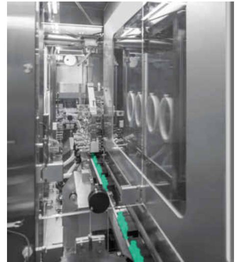
Die Füll- und Verschließmaschine AFG 5000 verarbeitet bis zu 480 Vials pro Minute
