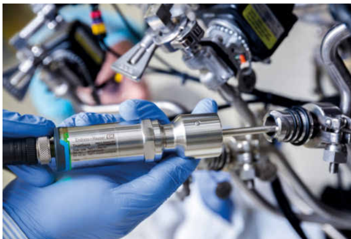
Die in den Sensoren erzeugten Selbstkalibrierdaten können vollständig integriert und archiviert werden
