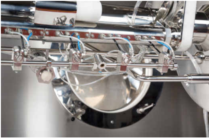
Der automatisch ausfahrbare Sprüharm mit beweglichen, selbstjustierenden Sprühdüsen ermöglicht variable Chargengrößen von zehn bis 100 %
