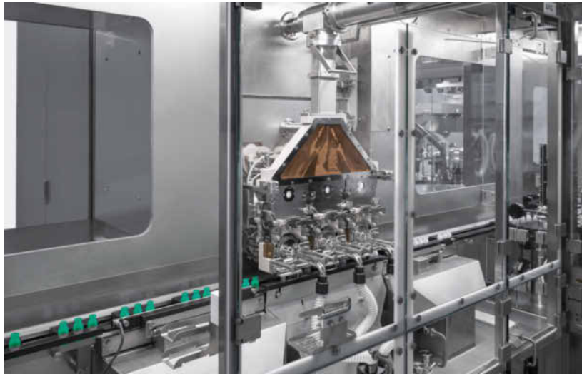
Das Transportsystem der AFG 5000 wechselt sicher zwischen kontinuierlichem und getaktetem Transport
