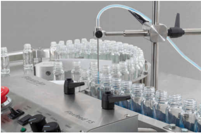
An der ersten Abfüllstation wird eine Kleinmenge eines Rohstoffes abgefüllt. Aufgrund des hohen Produktwertes kommt es dabei auf maximale Genauigkeit an.
